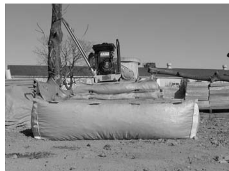
図-17 LS150の上にSS90を2段積層した場合の振動実験の様子
