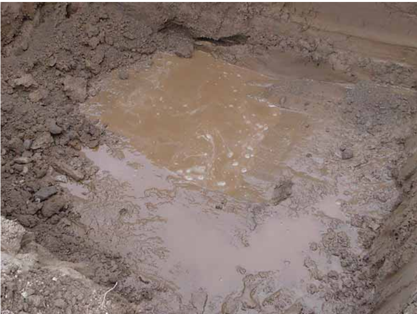
地盤A部 非常に液状化しやすい砂質土
